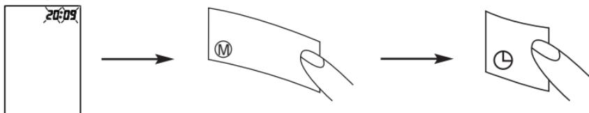
2. Der Monat kann nun durch die «M»-Taste eingestellt werden. Drücken Sie zur Bestätigung und zum Wechseln zur Tageseinstellung Uhrzeit-Taste.
